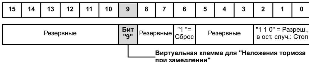
Если привод MOVIMOT® замедляется и при этом принимает управляющее слово с установленным битом 9, то преобразователь налагает тормоз напрямую (т. е. тормозом управляет MOVIMOT®) или через сигнальный релейный выход (тормозом управляет релейный выход) и блокирует выходной каскад.
